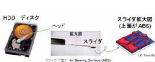
図2：HDDのスライダとABS
